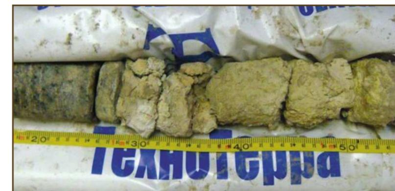
Рис. 12. Керн. Элементы гранитной плиты и известняка.
